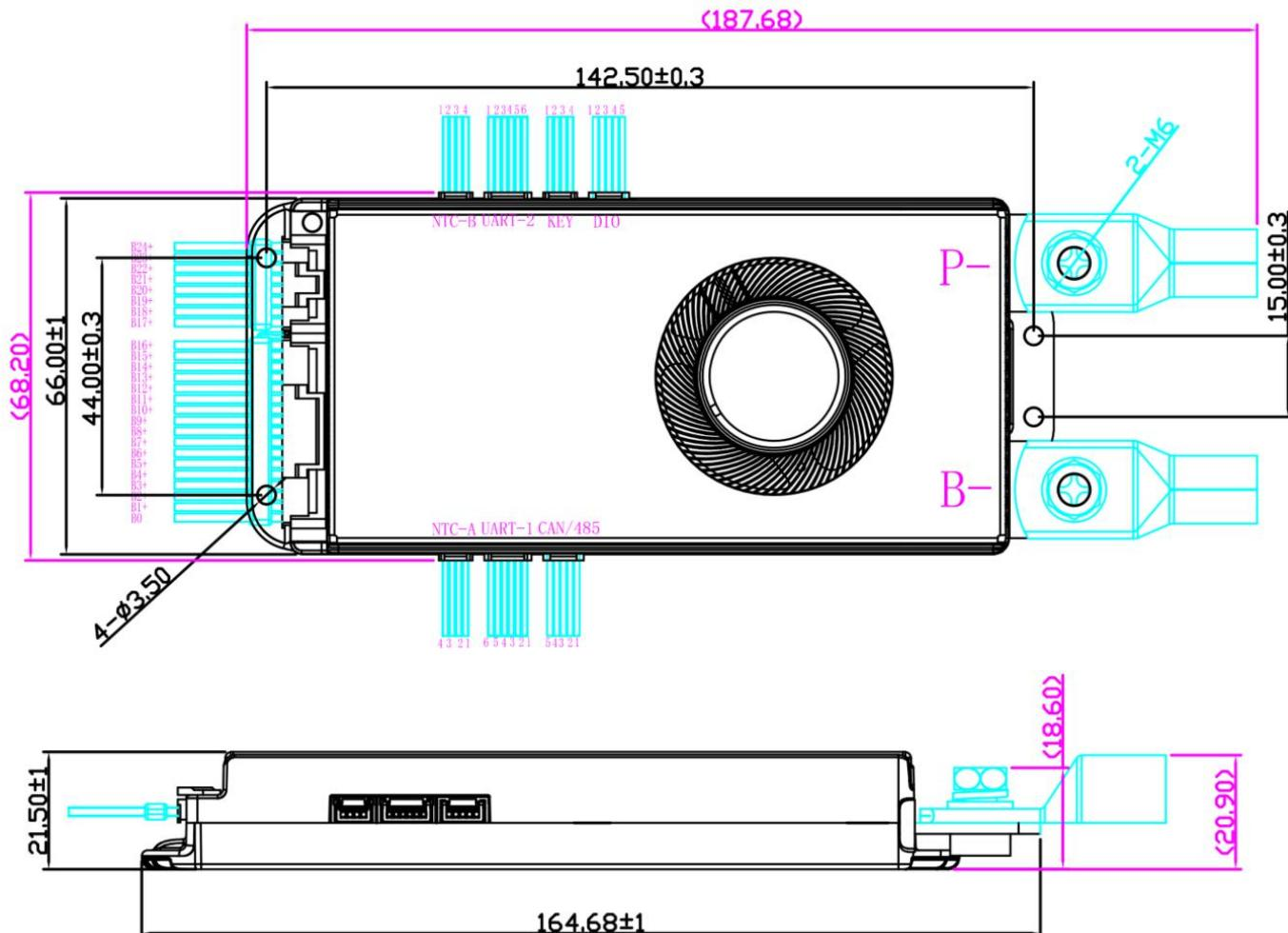
注：示意图最大串数全功能版本，以实物的配置为准。风扇气流朝板内。风扇表面禁止灌胶，会影响散热。
